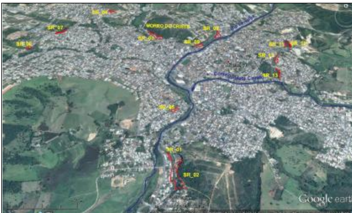
Figura 163 – Disposição dos setores de risco geológico alto e muito alto, relacionados aos processos de movimentação de massa e erosão
