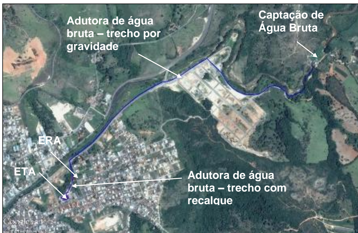
Figura 14 – Adutoras de Água Bruta
